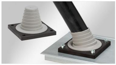
Le KEL-JUMBO flex est un système passe-câbles pour des câbles non confectionnés ayant un diamètre de 27 à 68 mm. Le KEL-JUMBO flex peut de préférence être utilisé pour introduire des câbles de puissance dans l'armoire électrique. Du fait du modèle pyramidal extrêmement souple, l'introduction et le positionnement du câble sont très simplifiés par rapport aux presse-étoupes traditionnels.
